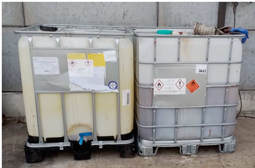
Illustration 14: exemple de GRV ouverts et contenant des fluides au niveau de la zone de dépôtage 26. Source IIC.
